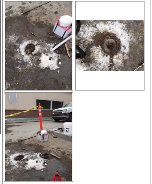
Purge water disposal: Pour on ground
