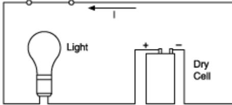
**Figure 4.10: Simple Circuit**
