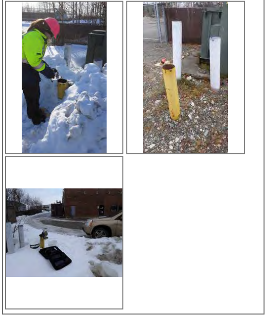
Purge water disposal: Pour on ground
